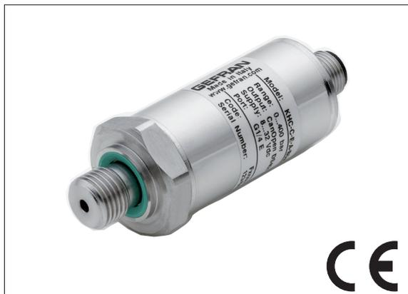
Преобразователи давления серии КНС основаны на пленочном чувствительном элементе, наваренном на диафрагму из нержавеющей стали.
